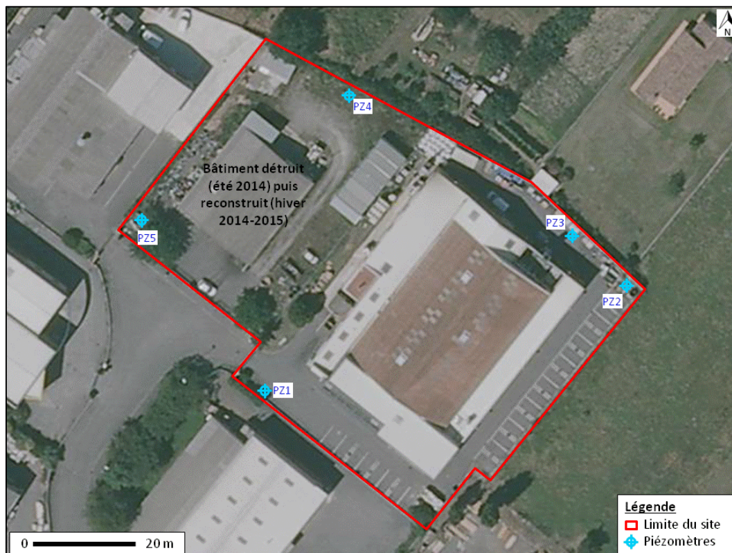
Figure 3: Localisation des piézomètres
